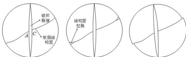
(a) 中心起裂 (b) 结构面局部拉裂 (c) 结构面剪切破坏
